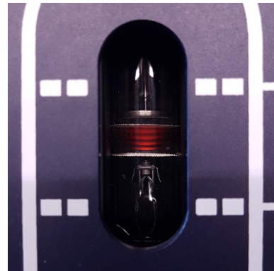
Abb. A20-3: Typische Leuchtschichten, die beim Frank-Hertz-Experiment mit einer Ne-Röhre beobachtet werden können
