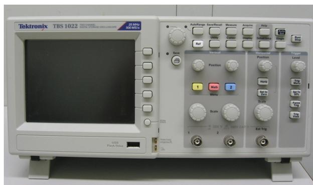
Abbildung 1: Digital-Speicher-Oszilloskop
