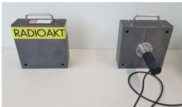
Abb. K10-1: Anordnung zur Bestimmung der Nullrate
